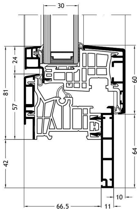
**Telaio a Z D2X**
